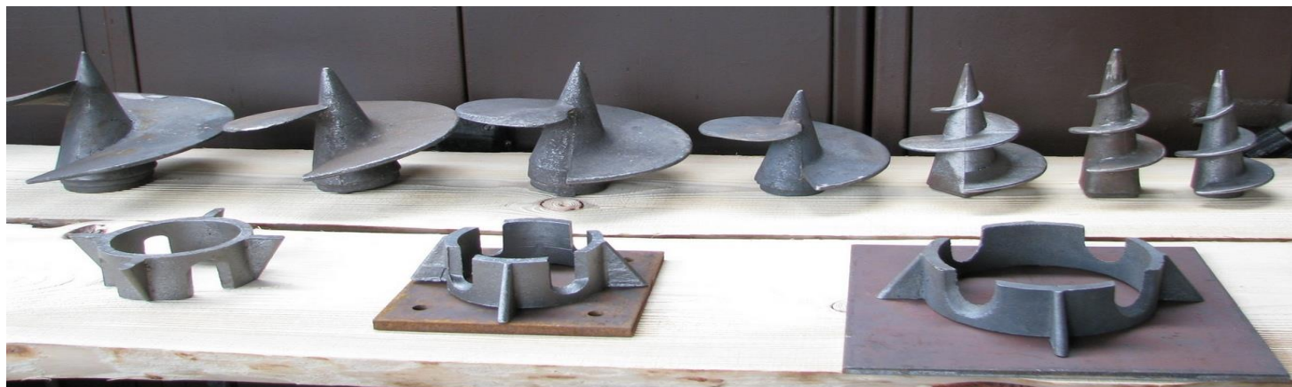
Литые наконечники для винтовых свай (Ст 30Л согласно ГОСТа 977-88)
